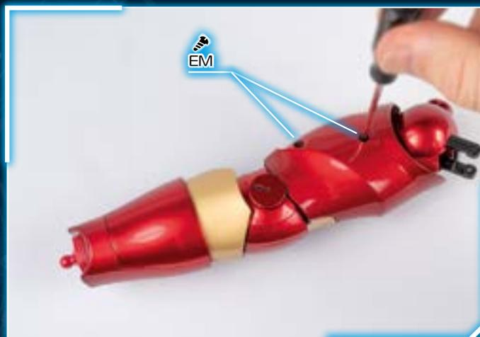
2- Скрепите соединенные детали двумя винтами EM, закрутив их в указанные отверстия детали (12B).
